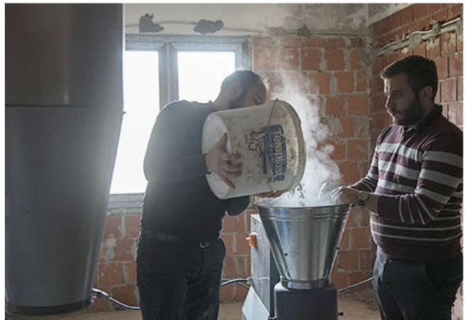
Смеса од пилевине и додатака се сипа у машину и на високој температури се добија финални производ пелет
